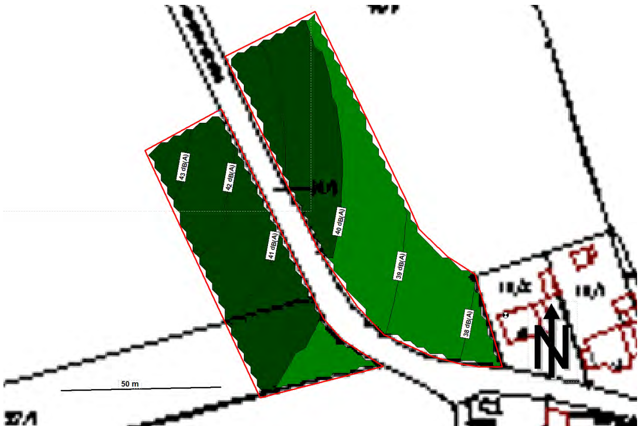
Abbildung 13: Darstellung der Beurteilungspegel des Betriebsgeräusches des geplanten Betriebes der Fa. Thedens während des Tageszeitraumes von 06.00 bis 22.00 Uhr in 4 m über Grund in der Fläche des geplanten WA-Gebietes südöstlich der Fa. Thedens.
