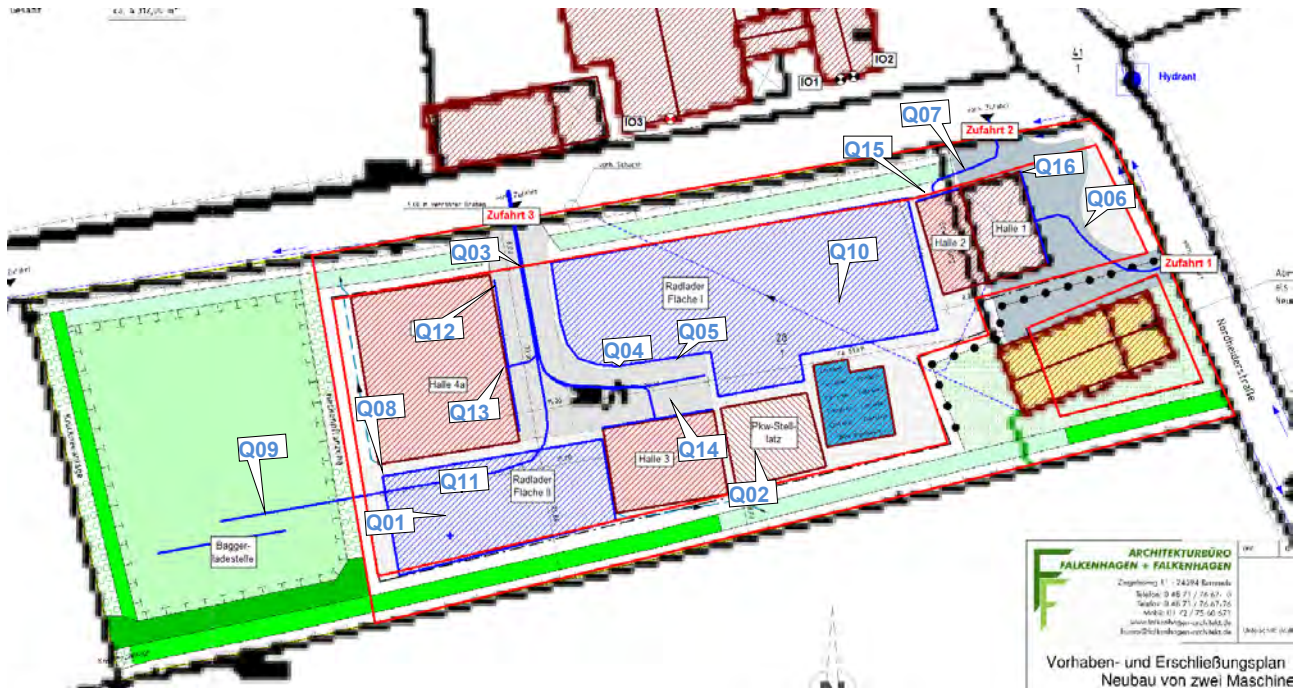
Abbildung 5: Zweidimensionale Darstellung des Ausbreitungsmodells mit Anordnung der Geräuschquellen auf dem Betriebsgrundstück
